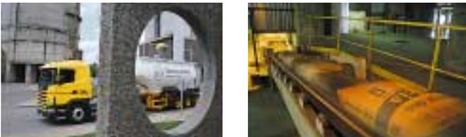
Acheminés vers les silos de stockage par transport pneumatique ou mécanique, les ciments quittent l'usine en sacs ou en vrac. Les sacs contiennent généralement 25 ou 50 kg de ciment et l'ensachage atteint fréquemment 100 tonnes par heure. Les sacs sont acheminés vers des palettiseurs qui constituent des palettes de 1500 kg transportées par camion. Le ciment livré en vrac constitue 70% de la production. Il est transporté par camion-citerne, par train ou par bateau.
